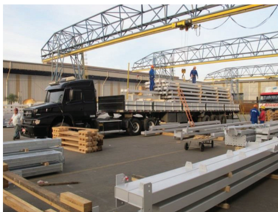
Figura 38: Embarque de estruturas de aço em caminhão (Foto: Sidnei Palatnik)
